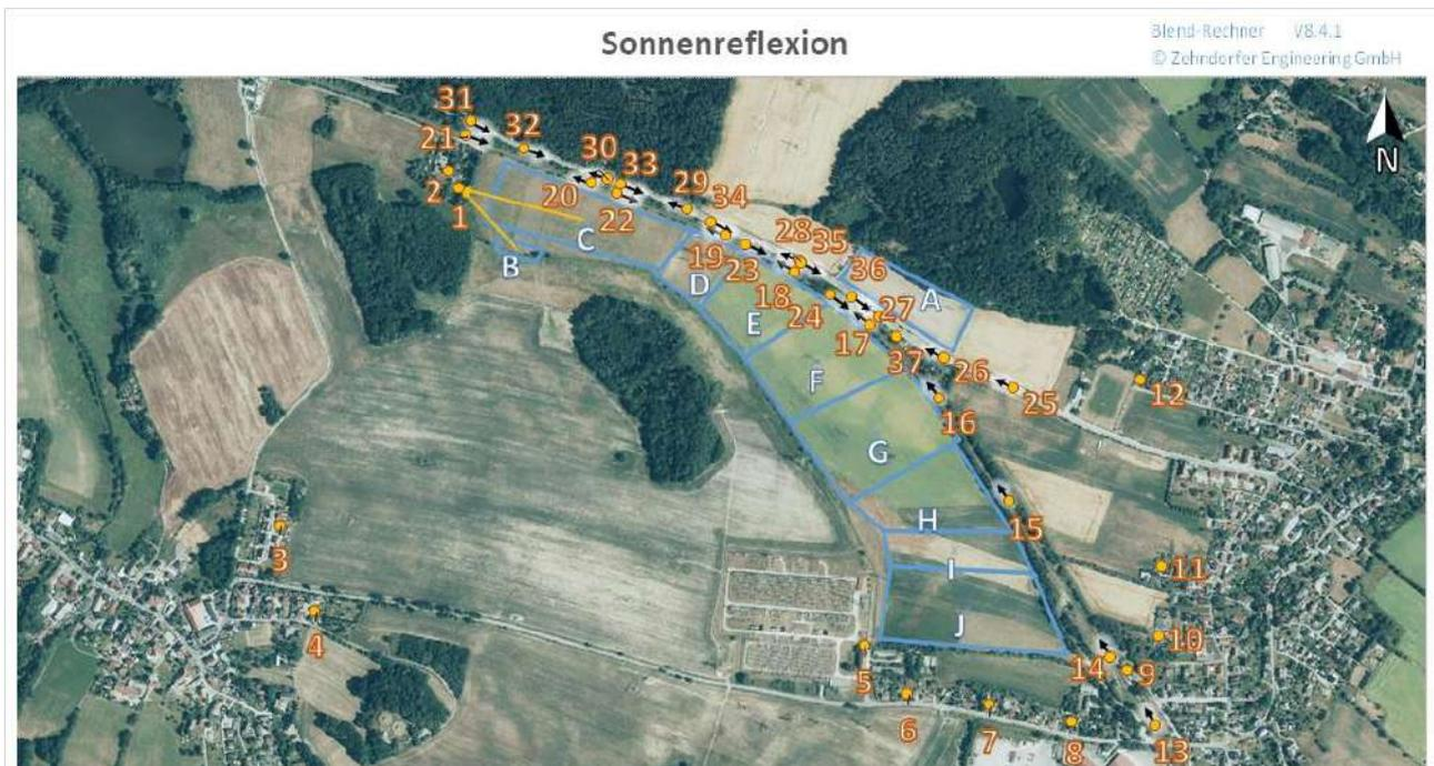
Abbildung 6 zeigt die Lage der Immissionspunkte (IP) und des PV-Feldes. Die Immissionspunkte wurden unter dem Kriterium ausgewählt, dass eine Sichtverbindung zur Vorderseite der PV-Module gegeben sein muss.
