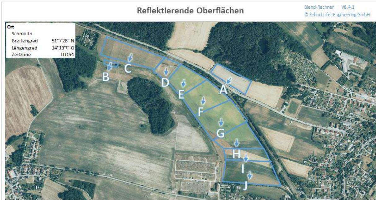
Die reflektierenden Flächen werden für die Berechnung in mehreren Vierecken modelliert.
