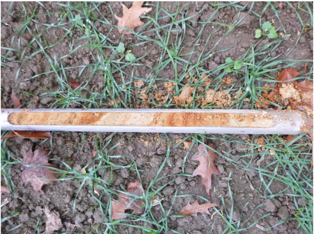
Bild 6: NO-Seite, Grobsand, mittelsandig, schwach feinsandig, bei 2,5-3,0 m.
