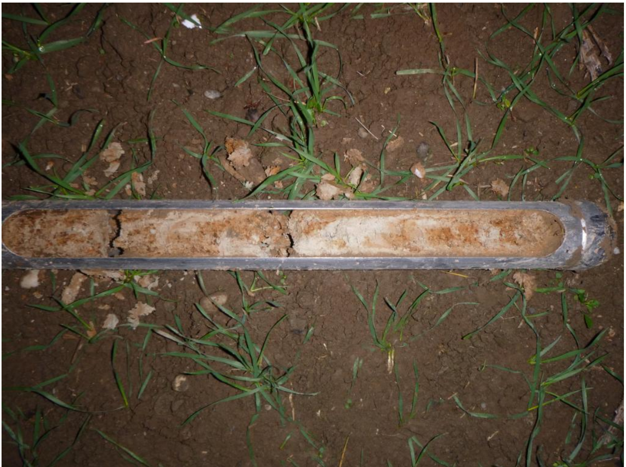
Bild 4: SW-Seite, Schluff, stark grobsandig, schwach kiesig, schwach tonig, bei 0,5-1,0 m.
