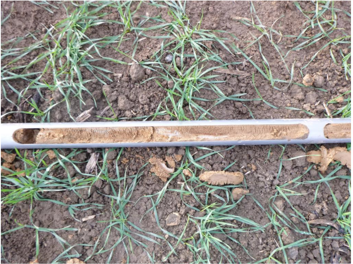
Bild 5: N-Seite, Schluff, stark feinsandig, schwach mittelsandig / tonig, bei 1,5-2,0 m.
